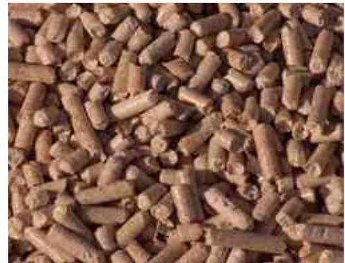
A causa della forma cilindrica e liscia e delle piccole dimensioni, il pellet tende comportarsi come un fluido, il che agevola la movimentazione del combustibile e il caricamento automatico delle caldaie. Il trasporto può avvenire con autobotti, dalle quali il pellet viene pompato direttamente nel serbatoio di stoccaggio dell'impianto.
